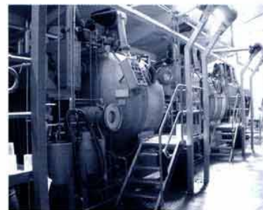
Färberei mit HT-Färbemaschinen unterschiedlicher Kapazität vom Typ Thies Luft-rotor
