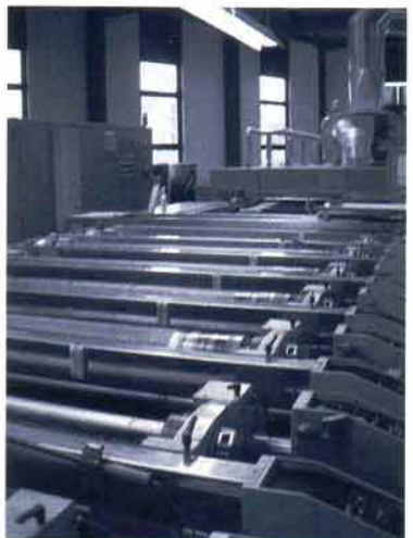
Auf dieser Druckmaschine wird gerade ein 4-farbiger Küpenätzdruck gefahren
